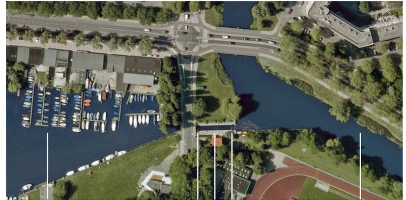
barragem móvel | câmara da eclusa (29 x 4 m) | barragem móvel
